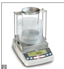
Jeu de détermination de la densité des matières liquides et solides avec une densité  $\geq 1$ , pour les modèles avec plateau de dimensions
